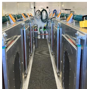
Figur 5.7. Søye i individbinge med fôropptaksmålinger med BioControl systemet med elektronisk vekt (venstre) og PAC kammerer (høyre). Bilde: Gareth Difford.
