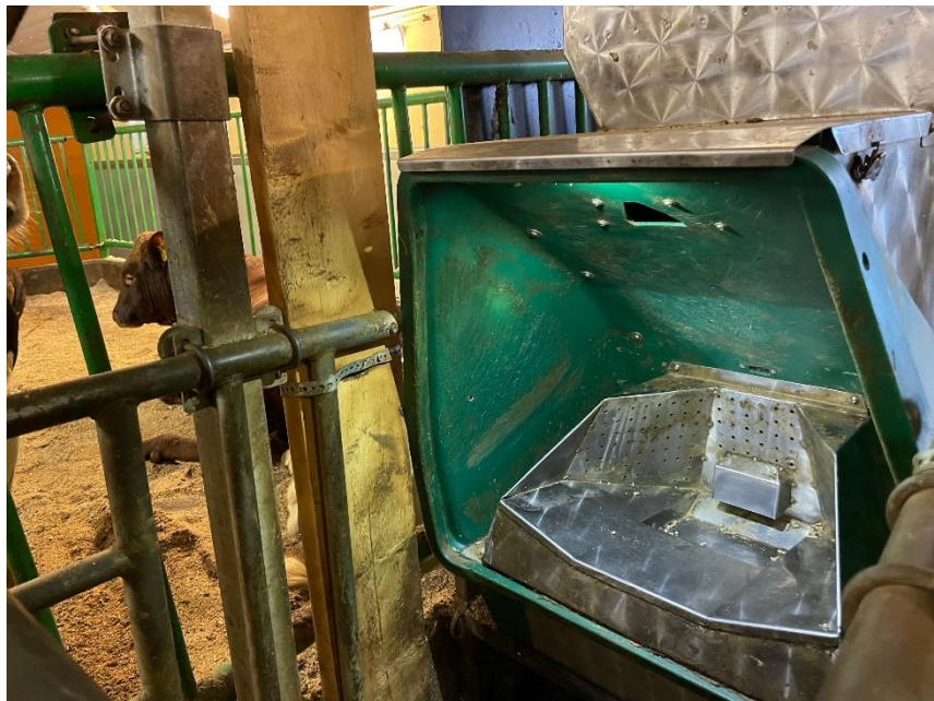
Figur 5.2. Målingsutstyr for daglig produksjon av metan ( \text{CH}_4 ) fra melkekyr (GreenFeed™ (C-Lock Inc., Rapid City, US. (Foto: Geno).
